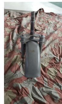
**Forcella telescopica idraulica x 1 sola ruota anteriore, post bellica.**
