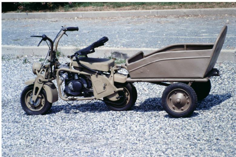
a due marce e, pensando ad un impiego fuoristrada, un riduttore a due velocità; il telaio venne completamente ridisegnato e si pensò di usare i tubi della sua struttura come silenziatori, con il risultato che l'AERMOTO emise sempre un rumore pazzesco, il manubrio venne sostituito da due leve, ripiegabili per l'avvolgimento, su cui erano sistemati tutti i comandi.
