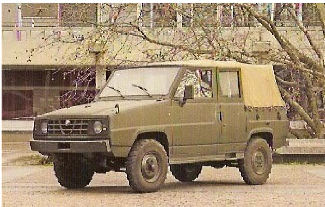
Prevista con diverse motorizzazioni: VM diesel 2400 cc a 4 cilindri e 3000 cc a 6 cilindri a V. passo di 2.35 o 2.75 m. portata utile di 1000 Kg. trazione posteriore con anteriore inseribile, telaio portante con carrozzeria imbullonata così da renderla robusta al punto da ospitare vari armamenti. Ne venne progettata anche una versione destinata al mercato civile, sia in versione chiusa che aperta
