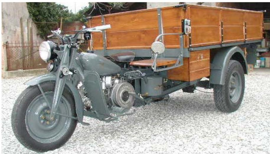
**Anche la Gilera produsse un veicolo simile: il Mercurio: cilindrata 497 cc. alesaggio/corsa: 84/90, potenza 20HP, velocità: 68 Km/h, lunghezza 3.52 m. larghezza 1.50 m.**
