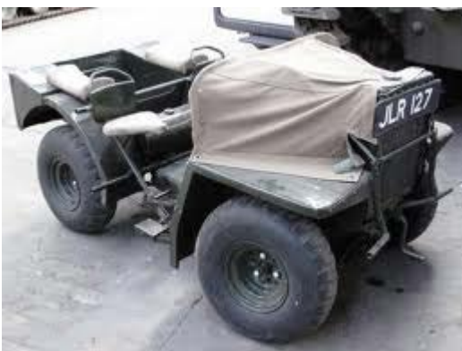
Un esemplare sopravvissuto di JAB vedere i sedili di tipi motociclistico ed il cofano in tela
