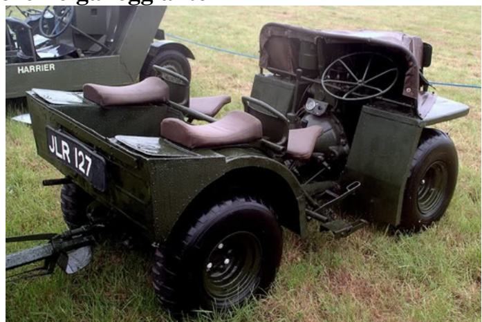
Un esemplare sopravvissuto di JAB vedere i sedili di tipi motociclistico ed il cofano in tela
